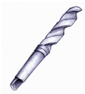
Rys. 2 Praca studencka – szkic odręczny wiertła wraz z wyznaczoną konstrukcyjnie linią śrubową.
